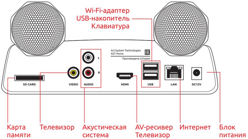
**Рис. 1** Разъёмы караоке-системы
